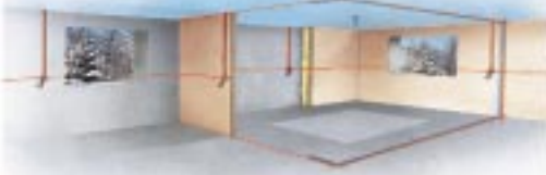
Alignement de Cloisons,
